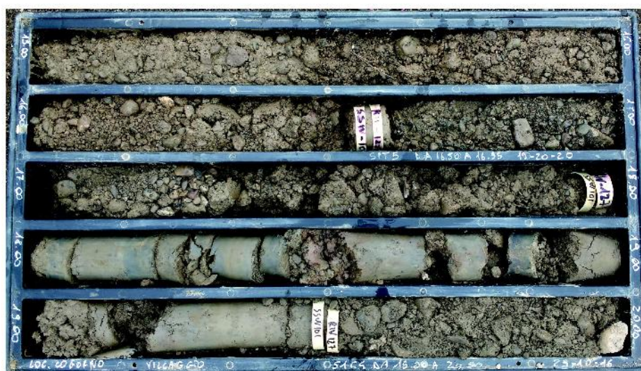
Comune di Cogorno, Villaggio Del Ragazzo Sondaggio S1 cassetta da 15,00 a 20,00 metri
