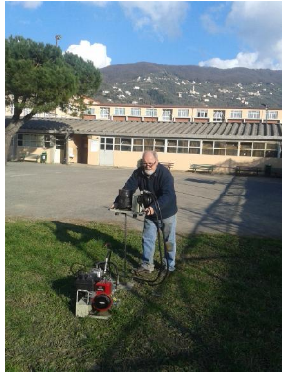
FOTO n.4 prova penetrometrica DPT n.2
