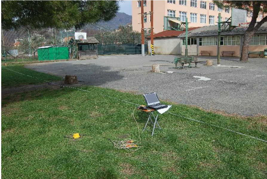
FOTO n.1 localizzazione geofono 3d per prova HVSR
