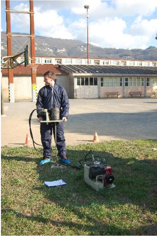
FOTO n.3 Prova penetrometrica DPT n.1
